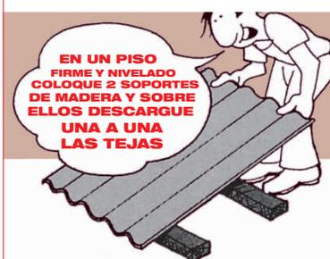
COLOQUE 2 SOPORTES DE MADERA SOBRE UN PISO PLANO, FIRME Y BIEN NIVELADO. LA DISTANCIA ENTRE SOPORTES DEBE SER IGUAL A LA MITAD DE LA LONGITUD DE LA TEJA QUE SE VA A ALMACENAR
